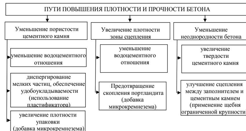
Рисунок 1. Пути повышения плотности и прочности бетона
