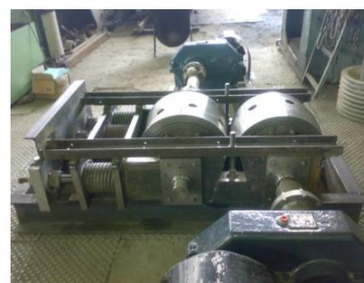
Рисунок 2. Пресс-валковый измельчитель коническими валками
