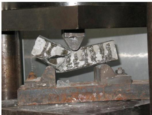
Рисунок 3. Характер разрушения бетонных призм
